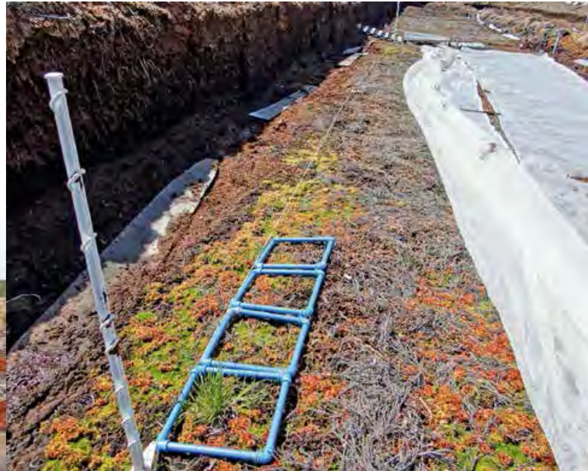
Figura 30. Muestra los resultados obtenidos aplicando la técnica de transferencia de una capa de musgo. En la figura se puede apreciar el restablecimiento del acrotelmo.
