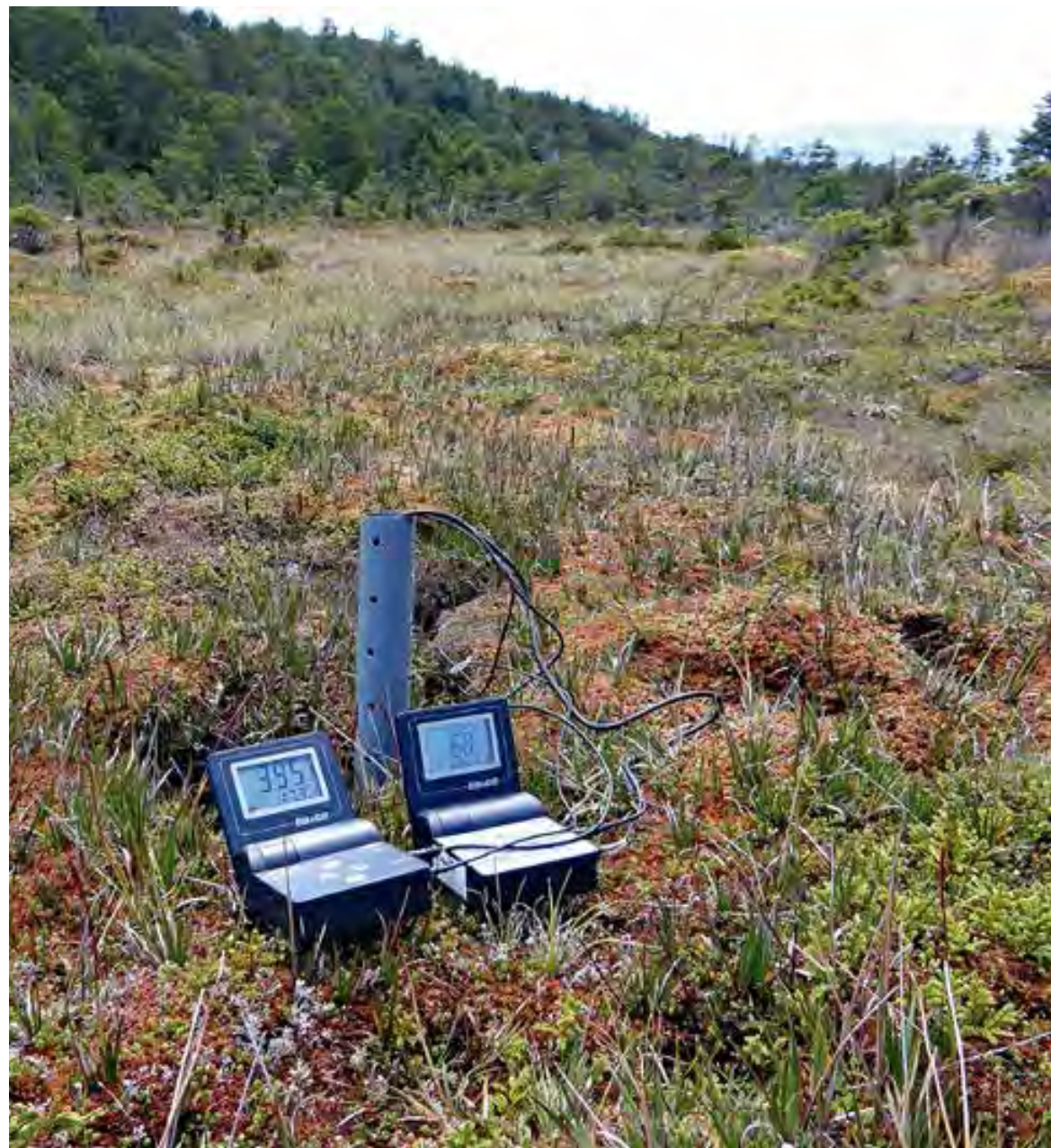
Figura 18. Se muestra en la imagen el sensor de conductividad, pH y temperatura registrando datos en el interior de un tubo de PVC que actúa como un pozo de agua.
