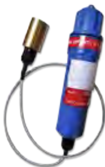
Figura 11. Esquema de un freatímetro que muestra como se utiliza estima el nivel freático (Fuente: Iturraspe, 2010).
