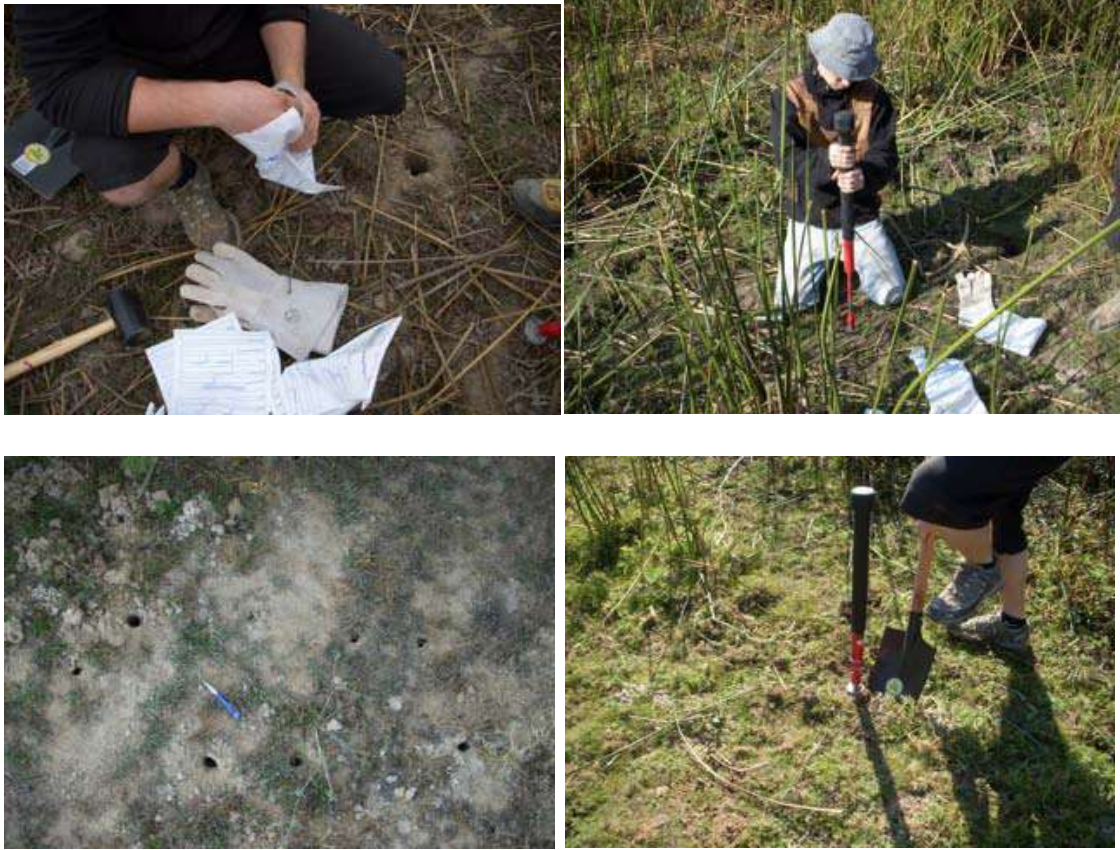
Figura 6. Proceso de toma de muestras y medición de densidad aparente en distintas asociaciones vegetacionales dentro del humedal, Abril 2010.
