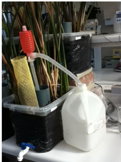
Figura 4: Vaciado de los humedales mediante un sifón.
