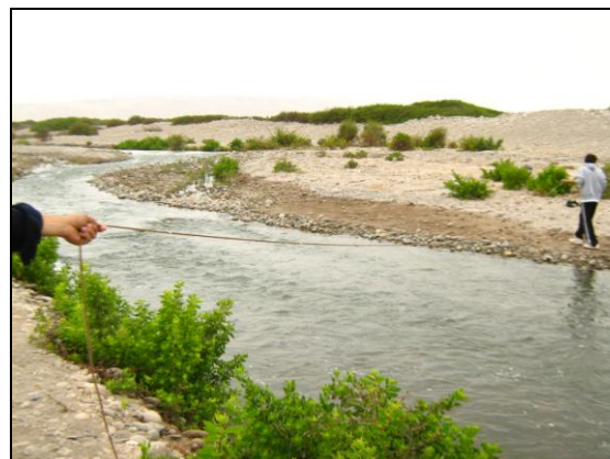
Figura 13. Medición ancho de cauce.
