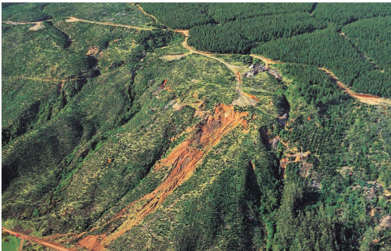
La construcción de caminos forestales exige la tala de vegetación y el movimiento de tierras y rocas para conseguir estructuras capaces de soportar el paso de vehículos pesados, aun en los períodos de condiciones ambientales adversas. Esta actividad ocasiona, inevitablemente, un aumento de la erosión, por lo que es altamente recomendable limitar al mínimo su longitud. Foto: Nicolás Pivonka.
