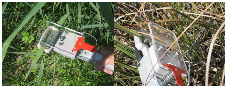
Figura 4.1.1.1. Ejemplo de medida en una hoja de carrizo (izquierda) y en una hoja de masiega (derecha) con el equipo IRGA.
